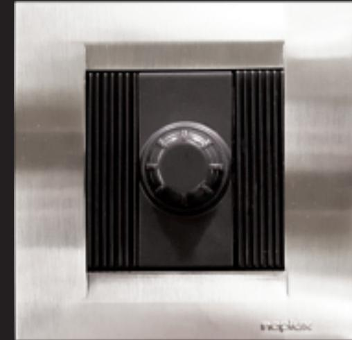
**LED dimeri serije Interio imaju naizmeničnu sklopku i rotacionu regulaciju svetla.** Dimeri regulišu osvetljenje dimabilne LED rasvete prednjom ivicom. Performanse je moguće optimizovati programiranjem jednog od 3 moda rada da bi se dimer prilagodio opterećenju. Dimeri imaju mogućnost podešavanja minimalnog osvetljenja kako bi se postigao optimalan opseg regulacije svetla i sprečilo treperenje na minimumu.
